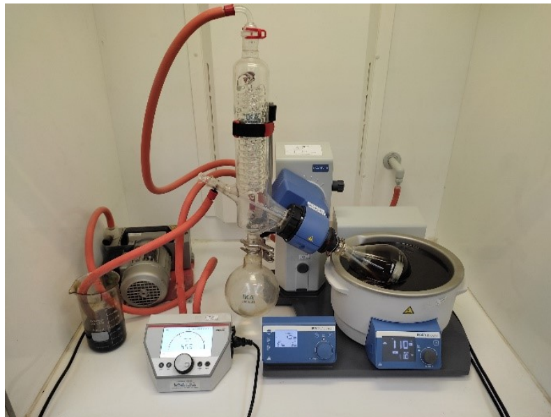
1. ábra: Beeresztőcsapos forgó bepárló, bitumen visszanyeréséhez.
