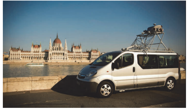
4. Ábra. A BKK Közút Zrt. Közúti Adatgyűjtő Rendszere [BKK Közút, KARESZ ismertető]
