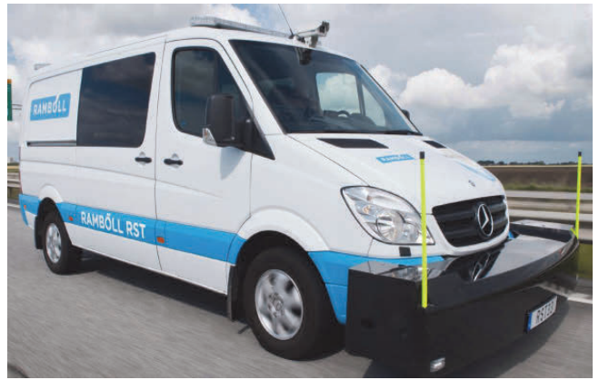
2. Ábra. A Magyarországon használthoz hasonló Ramböll RST tesztjármű [Ramböll: Vagytemätning – Vagnät]
