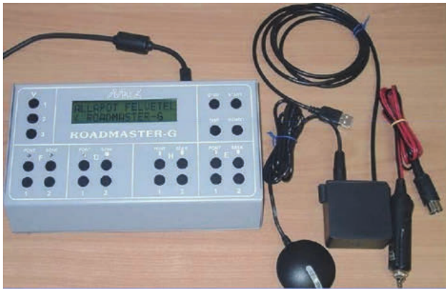
1. Ábra. ROADMASTER-G terepi adatfelvő készülék [Tóth, 2015]
