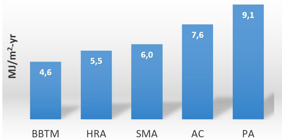
1. ábra: Az aszfalttípus-variánsok élettartama alatti összes fajlagos (1 m 2 -re vetített) energiaigény éves mennyisége (MJ/m 2 /év)
