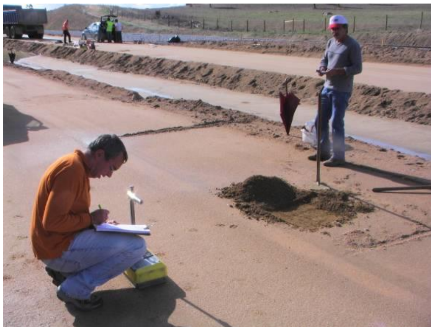
3. ábra: Izotópos tömörségmérés MC-3
