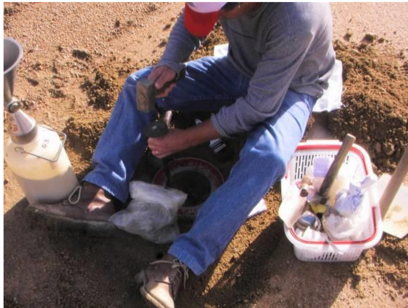
6. ábra: ASTM Sand-filling homok-kitöltés vizsgálat
