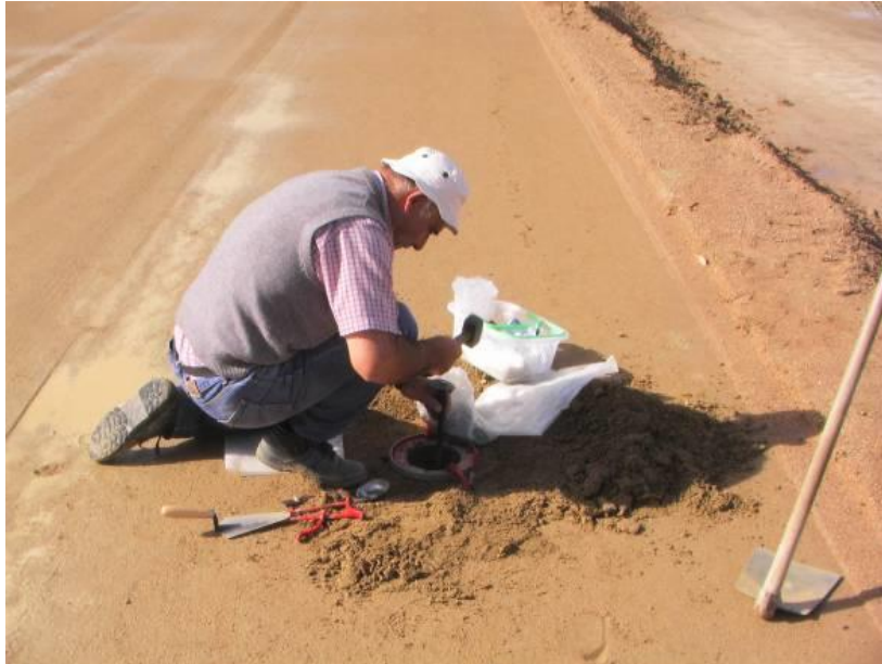
5. ábra: ASTM Sand-filling homok-kitöltés vizsgálat
