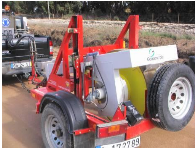
10. ábra: Portancemetre folyamatos teherbírás mérési módszer
