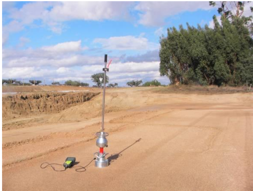
7. ábra: ANDREAS új dinamikus tömörség- és teherbírás mérő műszere
