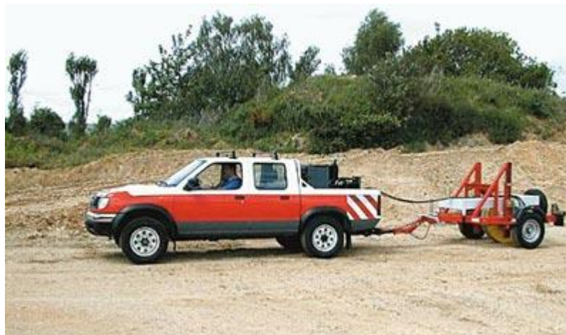
11. ábra: Portancemetre folyamatos teherbírás mérési módszer
