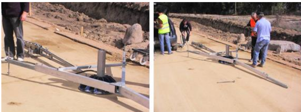
15. ábra: Statikus teherbírás vizsgálat d=600 mm tárcsával
