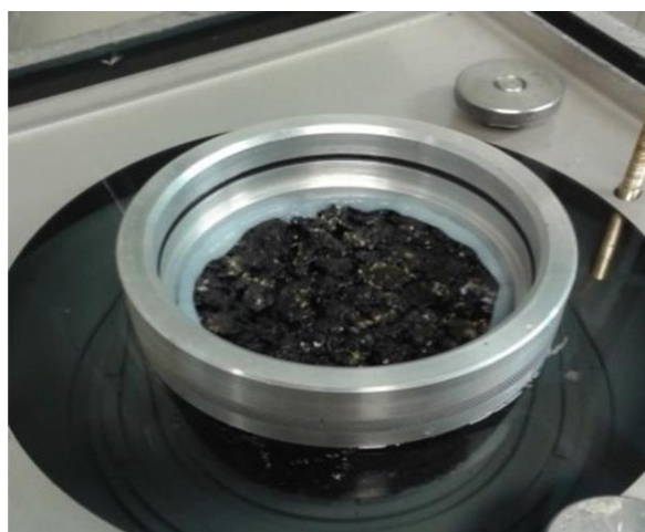
6. ábra: A vízszintes vízáteresztés mérésének előkészítése a) fúrt minta alsó síkjának paraffinnal történő bevonása b) vizsgáló feltét gyűrűjének rögzítése szilikon tömítőanyaggal és a vizsgáló berendezésbe helyezése száradás után
