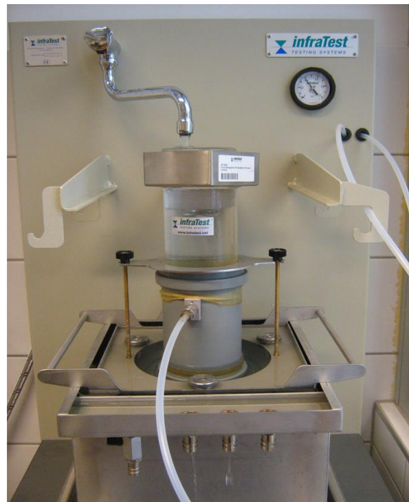
5. ábra: A függőleges vízáteresztés méréseinek legfontosabb lépései a) a minta elhelyezése, a próbatest felső síkjának vízszintbe állítása, b) gumiköpeny és feltét felhelyezése, és nyomás alá helyezése
