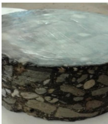
6. ábra: A vízszintes vízáteresztés mérésének előkészítése a) fúrt minta alsó síkjának paraffinnal történő bevonása b) vizsgáló feltét gyűrűjének rögzítése szilikon tömítőanyaggal és a vizsgáló berendezésbe helyezése száradás után
