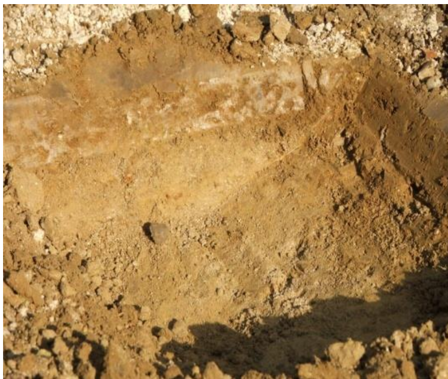
1. kép: Nedves kövér agyag talaj két évvel a beépítést követően
