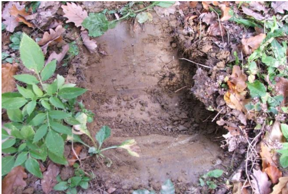
2. kép: Száraz mésszel stabilizált talaj két évvel a beépítést követően
