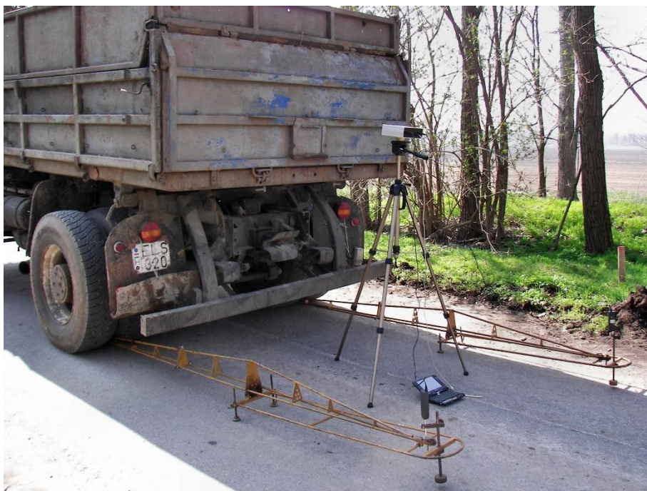
4. ábra: Az ABBA mérőeszköz a kísérleti úton
