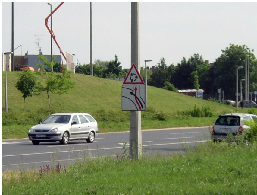
16. ábra: Kísérleti jelzőtáblák figyelmeztetnek a belső sávból kihajtás veszélyére a belépések előtt
